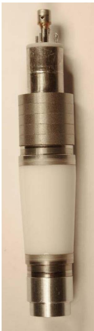
В генераторе нейтронов титановая или циркониевая мишень с растворенным в ней изотопом водорода тритием ( ${}^3_1\text{H}$ ) бомбардируется дейтонами (ядрами тяжелого водорода  ${}^2_1\text{H}$ ) ускоренными линейным ускорителем под напряжением около  $10^5\text{В}$ .
